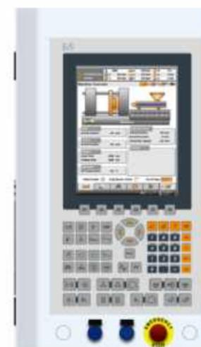
Интегрированная система управления на базе программируемого компьютерного контроллера компании B&R (Австрия).
