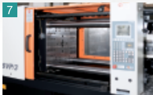
7 Усиленная подвижная и неподвижная плита повышают стабильность производства и качество изделий
