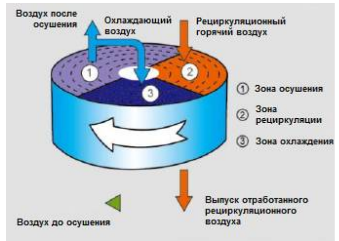
Ротор Принцип работы
