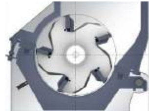
Два фиксированных и пять вращающихся лезвий
